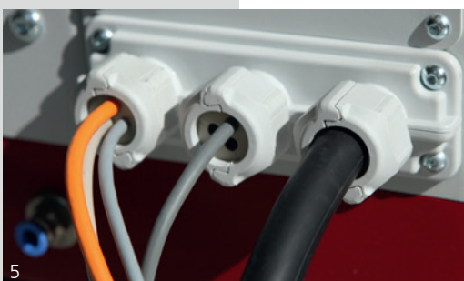
Abb. 5: Der fertig montierte UNI FLANSCH führt unterschiedliche Daten-, Steuer- und Energiekabel mit Schutzart IP 66 und hoher Zugentlastung.
