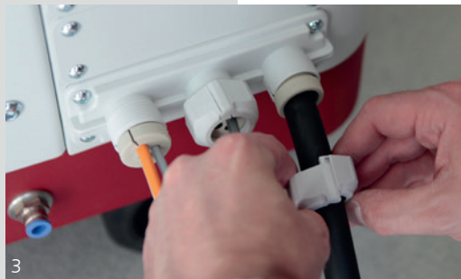
Abb. 3: Ist der UNI FLANSCH in der Gehäusewand verschraubt, werden die durchgeführten Kabel von den geschlitzten Dichteinsätzen umschlossen und die geteilte Druckschraube platziert.
