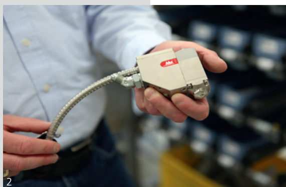
Abb. 2: Mit diesen Elektroventilen können die Baumer hhs Geräte bis zu 400 Klebepunkte in der Sekunde auf das Trägermaterial aufbringen.
