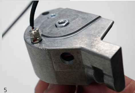
Abb. 5: Um die dünnen Sensorkabel zu schützen, werden sie mit einem Schrumpfschlauch überzogen, bevor sie durch die Kabelverschraubung geführt und montiert werden.
