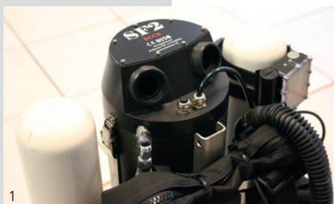
Abb. 1: Die blueglobe in M12 sitzt im sogenannten Kopf des Kreislaufatemgerätes. (Bild: Weber) Fig. 1: blueglobe size M12 sits in the head of the rebreather. (Photo: Weber)
