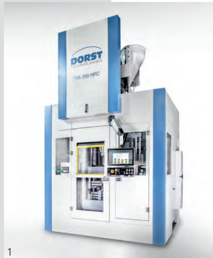
Abb. 1: Auf den mechanischen, elektrischen oder hydraulischen Pressautomaten wie der TPA 250HPC entstehen Produkte aus Metall- und Keramikpulver. (Bild: Dorst)
