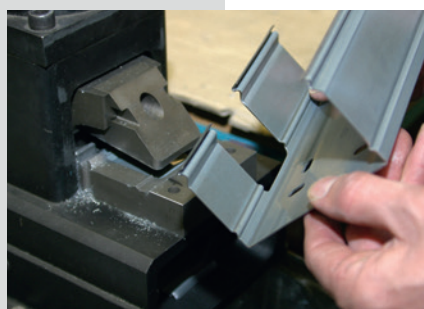
Abb. 1 Mit dem Ausklinkmodul werden seitliche Kanalausbrüche in Sekundenschnelle realisiert. Breitere Ausbrüche gelingen, indem der Anwender das überschüssige Blech in mehreren Arbeitsgängen nebeneinander ausklinkt.
