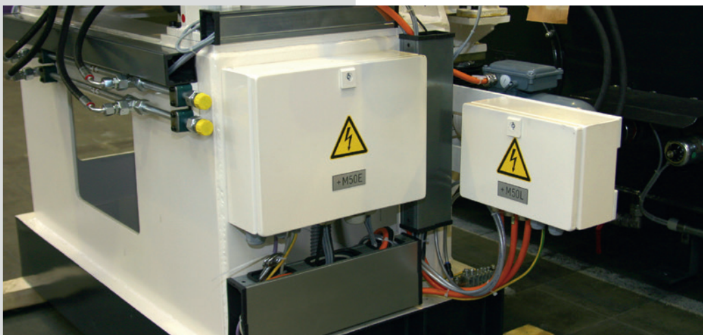
Abb. 1 Kabel aus verschiedenen Maschinenteilen – durch PIK-Kanäle sicher geführt – laufen in einem breiten Kanalstück unter dem Kompaktgehäuse zusammen.
