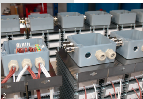
Abb. 2: Für die zuverlässige Kabeleinführung in die Gehäuse der Bremswiderstandssysteme setzt KOCH auf das PFLITSCH-UNI Dicht-System. (Bild: Walter Lutz) Fig. 2: KOCH relies on the PFLITSCH UNI Dicht system for reliable cable entries into brake resistor system housings. (Photo: Walter Lutz)
