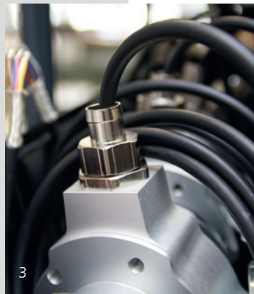
Abb. 3+5: Unter harten Einsatzbedingungen von -40 °C bis +120 °C gewährleistet die UNI Dicht Kabelverschraubung an diesem kompakten Drehzahlsensor die hohe Schutzart IP 68. Die Schlauchdruckschraube macht's möglich, einen Schutzschlauch direkt mit der Kabelverschraubung zu kombinieren, um die Sensorleitungen mechanisch besser zu schützen. (Bild: PFLITSCH)
