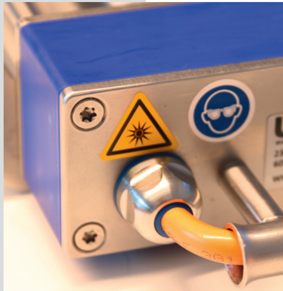
Abb. 4: orca führt das Kabel zunächst geschützt durch den Edelstahlgriff, bevor es durch die Kabelverschraubung blueglobe CLEAN Plus sicher mit IP 69K ins Gehäuse des Bandentkeimers eingeführt wird. (Bild: PFLITSCH/Lutz)
