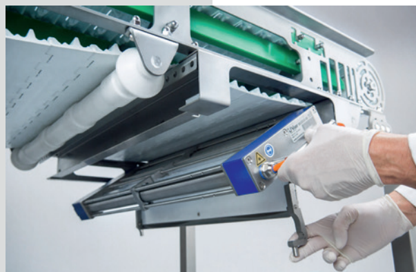
Abb. 2: Die UVpro-Bandentkeimer sitzen in der Regel unterhalb der Förderbänder. Heruntergeklappt lässt sich die gesamte Einheit bestens reinigen. (Bild: orca) Fig. 2: The UVpro belt disinfectors usually sit under the conveyor belt. They swing down to allow the whole unit to be completely cleaned. (Photo: orca)
