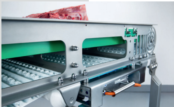
Abb. 1: Mit den UVpro-Bandentkeimern werden z. B. Förderbänder in der fleischverarbeitenden Industrie dauerhaft keimfrei gehalten. (Bild: orca) Fig. 1: Using the UVpro belt disinfectors keeps e.g. conveyor belts in the meat processing industry continuously germ-free. (Photo: orca)
