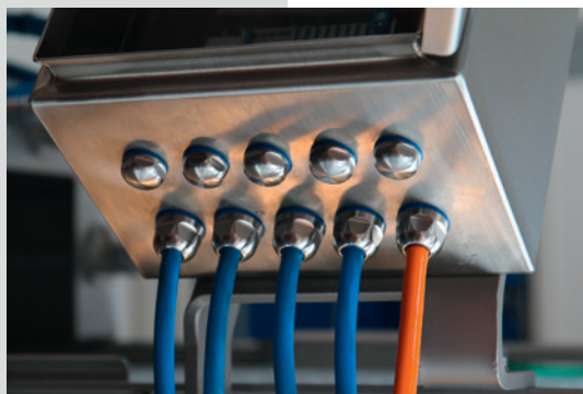
Abb. 5: Auch beim Bediengehäuse setzt orca mit der blueglobe CLEAN Plus auf Design und Hygiene-Sicherheit. Blindstopfen (obere Reihe) verschließen ungenutzte Bohrungen im Gehäuse. (Bild: PFLITSCH/Lutz)
