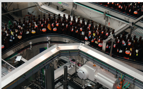
Abb. 3: Bestmöglichen mechanischen Schutz bieten die Deckel der Gitter-Kanäle, die Rothaus sauber verschweißt. (Bild: Lutz)
