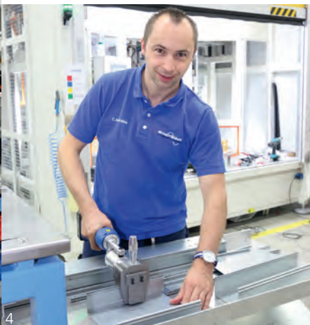
Abb. 4: „Mit den akkubetriebenen Ausklinkeinheiten von PFLITSCH können wir sekundenschnell Ausbrüche in die Kanalseitenwände einbringen, erklärt Christian Schächtele. (Bild: Lutz)
