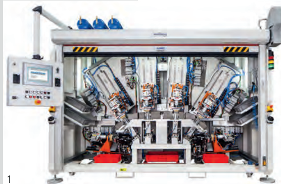
Abb. 1: Als Pionier des Ultraschall-Stanzens hat SONOTRONIC für die Bearbeitung von Stoßfängern ein neues Konzept entwickelt, in dem das Stanzen, das Konus-Anprägen und das Fügen in einem Vorgang zusammengefasst sind. (Bild: SONOTRONIC)
