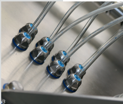
Abb. 3: Die Kabelverschraubung blueglobe CLEAN Plus in der Kundenanwendung. (Bild: Lutz) Fig. 3: The blueglobe CLEAN Plus is shown in application. (Photo: Lutz)
