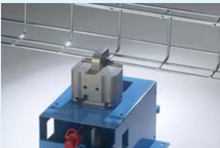
Auslinkprozess Notching out process
