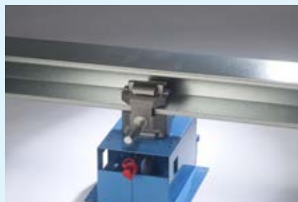
Auslinkprozess Notching out process
