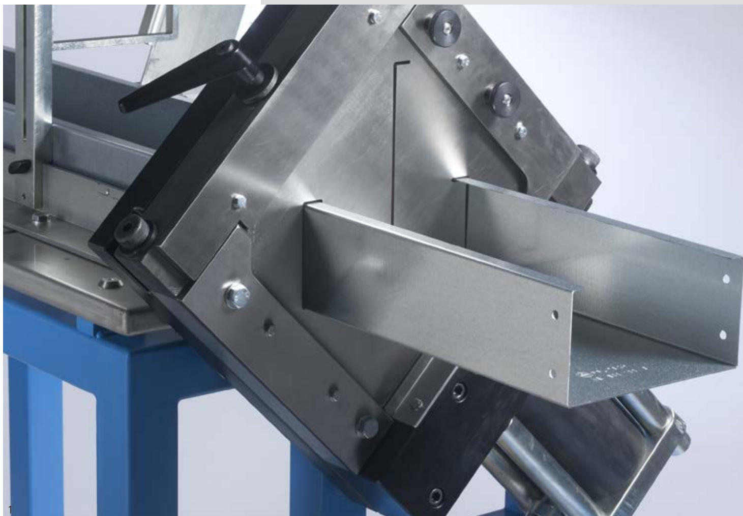
Abb. 1 – Passende Schneidplatten für jede Kabelkanalgröße bis 200 mm Fig. 1 – Different cutting plates for any size of trunking up to 200 mm
