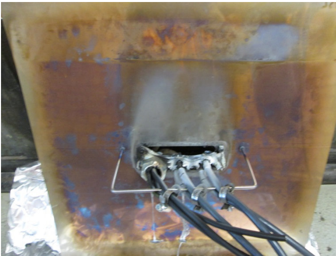
Schaden Feuer abgewendete Seite Damage unexposed side
