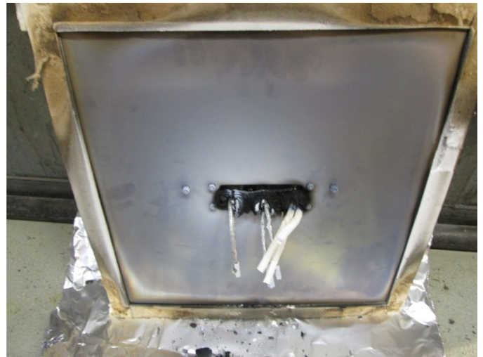
Schaden beflamnte Seite Damage exposed side
