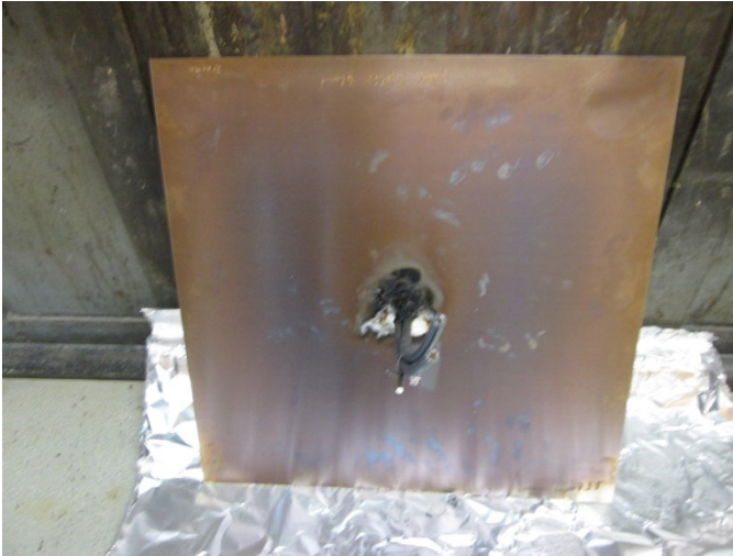
Schaden Feuer abgewendete Seite Damage unexposed side
