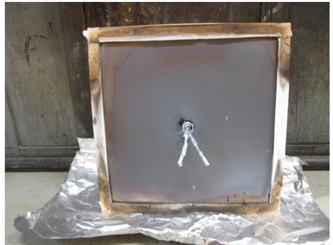
Schaden beflamnte Seite Damage exposed side
