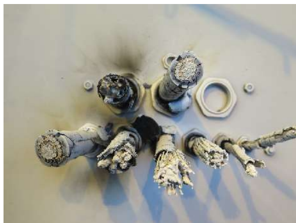
Schaden, beflamnte Seite Damage, exposed side
