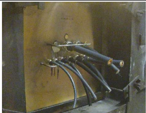
Schmelzen der Dichteinsätze Melting of sealing inserts Nach ca. 15 Minuten After approx. 15 minutes
