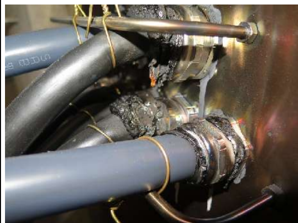
Schaden, unbeflamnte Seite Damage, unexposed side
