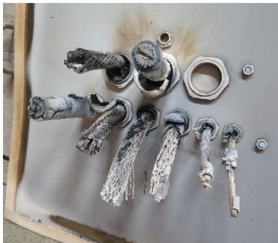
Schaden, beflamnte Seite Damage, exposed side
