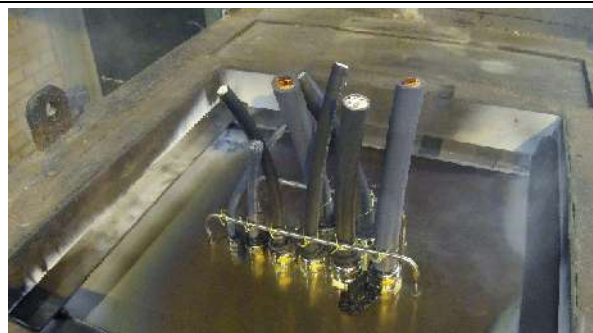
Schmelzen der Dichteinsätze Melting of sealing inserts Nach ca. 15 Minuten After approx. 15 minutes
