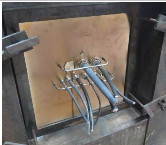
Schmelzen der Dichteinsätze Melting of sealing inserts
