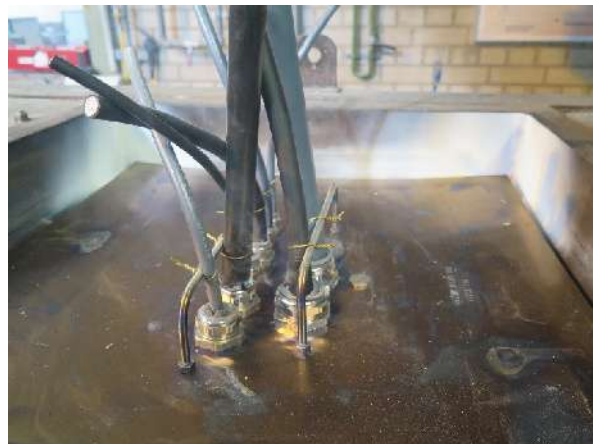
Nach ca. 31 Minuten – Versuchsende After approx. 31 minutes – End of test
