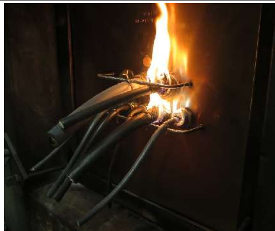
Anhaltende Flammen – Versagen hinsichtlich des Raumabschlusskriteriums Sustaining flames – Failure regarding the integrity criteria
