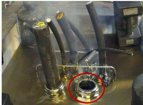
Abfallen der Dichseinsatzes → Versagen hinsichtlich des Raumabschlusskriteriums Falling off of the sealing insert Failure regarding the integrity criteria
