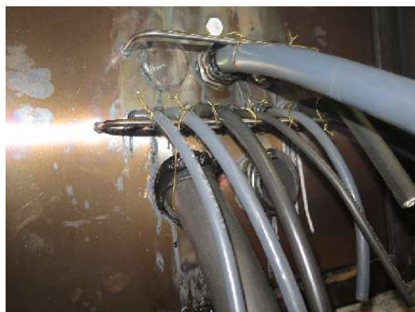
Schaden, unbeflammte Seite Damage, unexposed side
