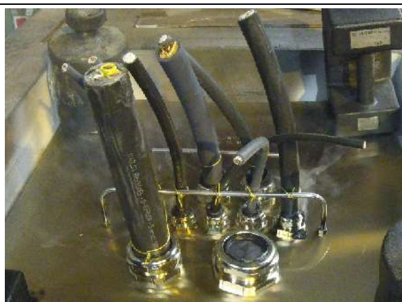
Schmelzen der Dichteinsätze & Rauchaustritt Melting of sealing inserts & smoke emission
