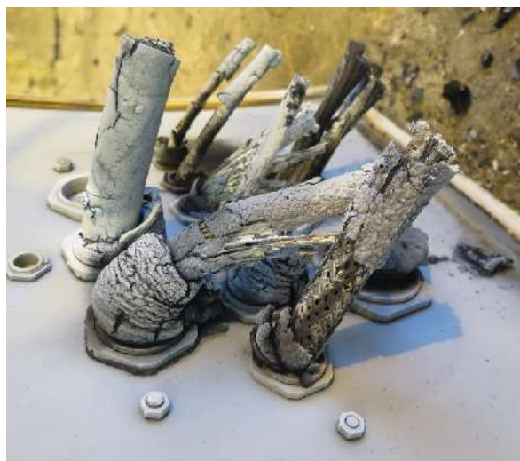
Schaden, beflamnte Seite Damage, exposed side
