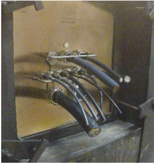
Schmelzen der Dichteinsätze Melting of sealing inserts
