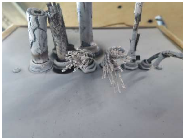
Schaden, beflamnte Seite Damage, exposed side
