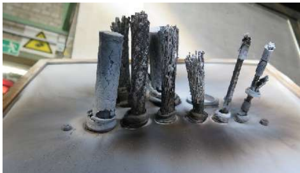
Schaden, beflamnte Seite Damage, exposed side
