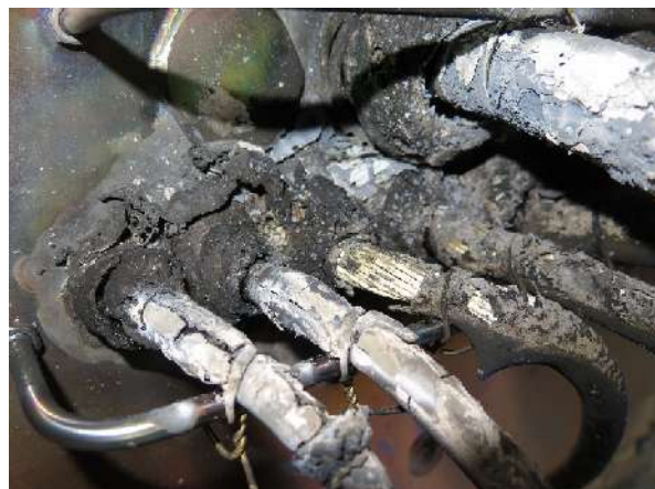
Schaden, unbeflammte Seite Damage, unexposed side
