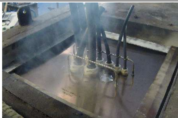
Schmelzen der Dichteinsätze Melting of sealing inserts
