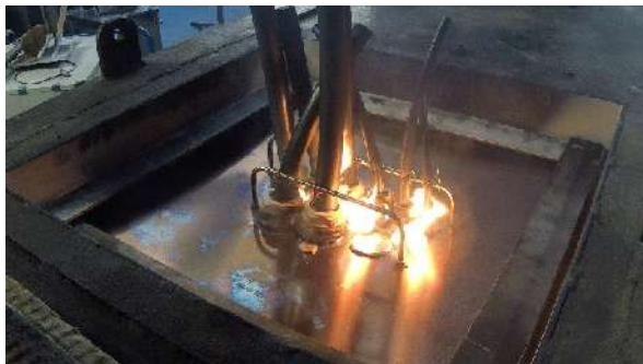
Anhaltende Flammenbildung → Versagen hinsichtlich des Raumabschlusskriteriums Sustaining flames Failure regarding the integrity criteria
