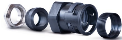
Darstellung ähnlich – die Druckschrauben werden für das Führen der Wellrohre mit PA umspritzt
