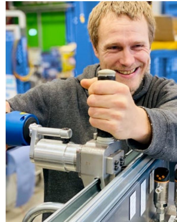
Auch das akkubetriebene Ausklinkwerkzeug zum Anfertigen seitlicher Ausbrüche fand bei den SEMA-Monteuren großen Anklang, da sich auch montierte Kabelbauteile damit bearbeiten lassen.
