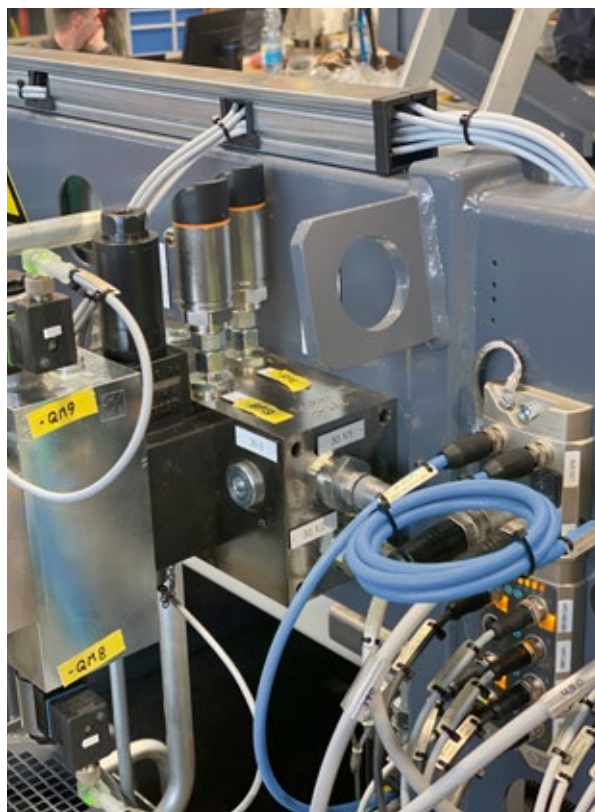
Für die Verlegung von Kabel und Leitungen auf der untersten Installationsebene kommt der kompakte PIK-Kanal zum Einsatz. Kabelschutzteile an Kanten und Ausbrüchen verhindern die Beschädigung der Kabel.
