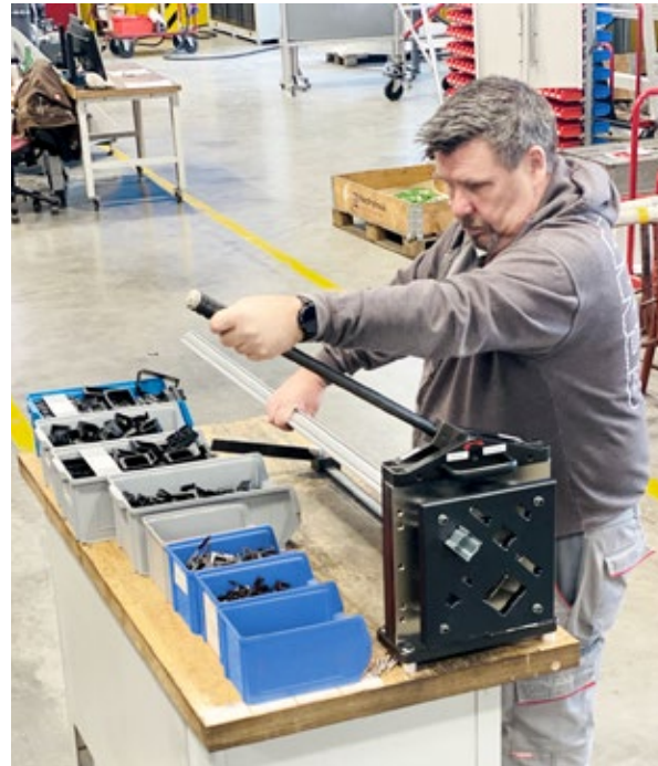
Die MiniCut wurde auf eine mobile Werkbank montiert, um sie schnell und einfach an jeden beliebigen Montageort bringen zu können.
