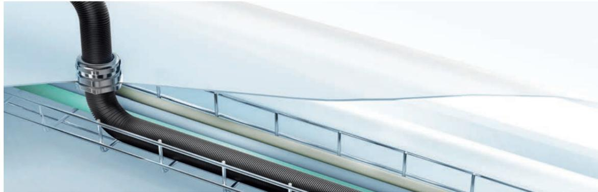
Messing vernickelt mit O-Ring aus HNBR Metrisches Gewinde nach EN 60423 Schutzart IP 68 bis 10 bar Gefährdungsklasse EN 45545-2: HL3
