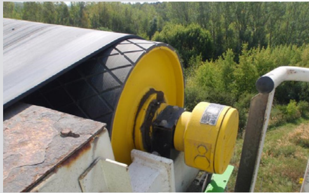
Abb. 3: Die RULMECA-Trommelmotoren – hier im Outdoor-Einsatz bei einer Baumaschine – müssen enorme mechanische Beanspruchungen aushalten. Eine robuste Konstruktion und hohe Schutzgrad mit mindestens IP 66 sind daher zwingend notwendig. (Bild: RULMECA)
