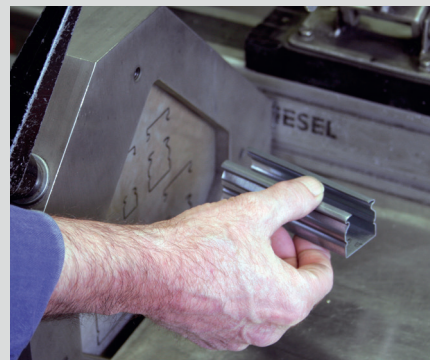
Abb. 1: Die HS PIKCut ist eine Handschere für PIK-Kanäle von 15 x 15 mm bis 60 x 60 mm und beschleunigt das Ablängen von Kanälen.
