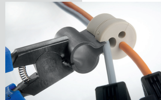
Abb. 5: Mit der Spreizzange lässt sich das Kabel in den geschlitzten Dichteinsatz einlegen. Fig. 5: The expanding pliers allows the cable to be placed into the slit sealing insert
