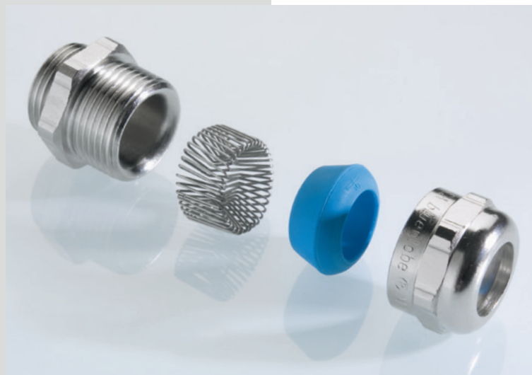
Abb. 1 Die blueglobe TRI mit dem kugelförmigen, blauen Dichteinsatz und mit ihrer innovativen Triangelfeder trennt erstmals die Schirmung von der Abdichtung.
