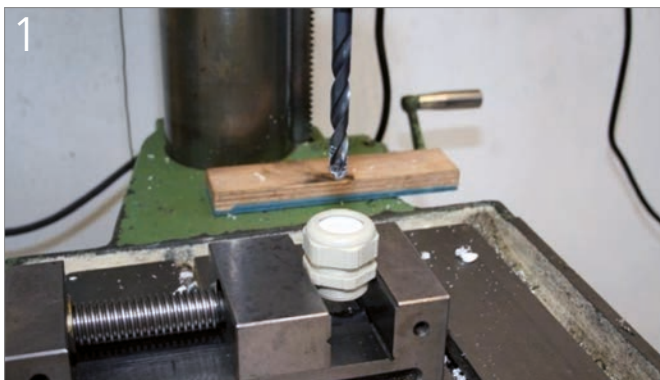
Montage des Dichteinsatzes in einem passenden Verschraubungskörper
