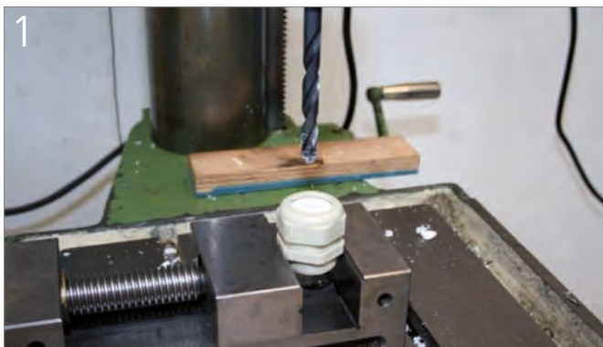
Montage des Dichteinsatzes in einem passenden Verschraubungskörper
