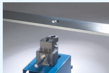
Ergebnis Stanzprozess Result of the punching process
