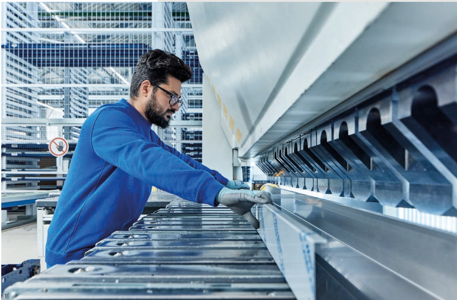
Abb. 1 – Umformung der Bleche zu Kabelkanalbauteilen Fig. 1 – Forming the sheet into trunking components
