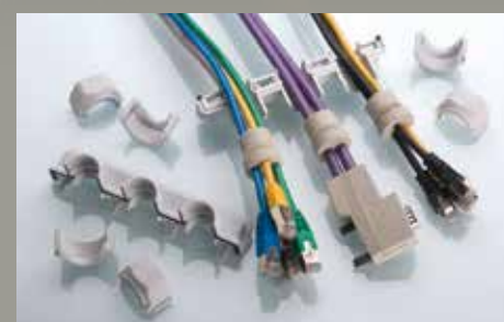
Der UNI FLANSCH™ für Industriestecker-Ausbrüche ist komplett teilbar: Das erleichtert die Montage und ermöglicht den Einsatz vorkonfekzionierter Kabel. (Bild: PFLITSCH)
