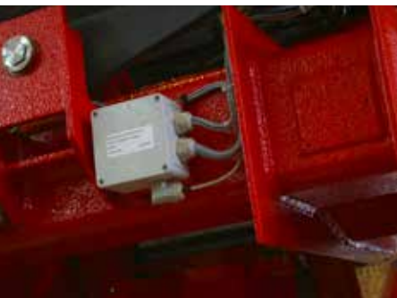
Drei Varianten an einem Verteilergehäuse der Lafette: Je nach Einbausituation nutzt Metz Standard-, Mehrfach- oder Winkel-Kabelverschraubungen aus dem UNI Dicht®-Systembaukasten. (Bild: PFLITSCH/Lutz)
