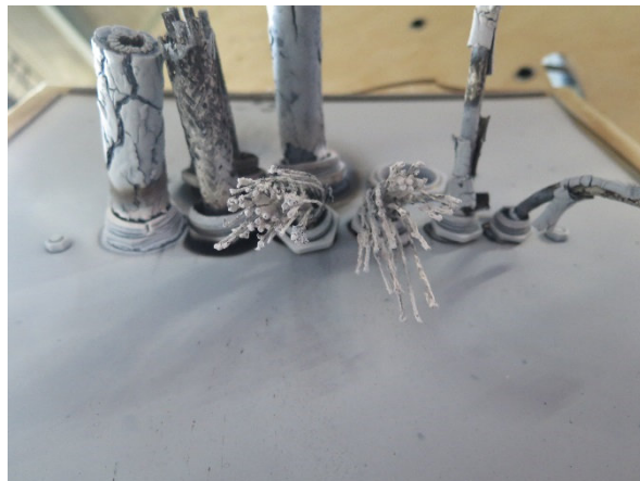
Schaden, beflamnte Seite Damage, exposed side
