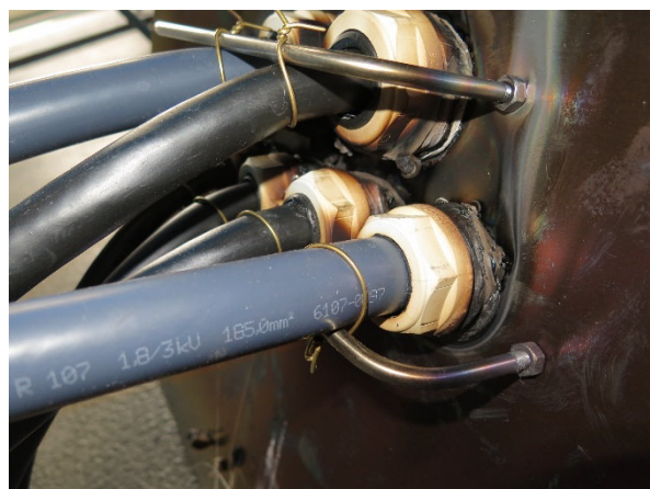
Schaden, unbeflammte Seite Damage, unexposed side
