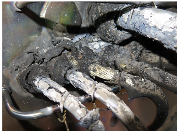
Schaden, unbeflammte Seite Damage, unexposed side
